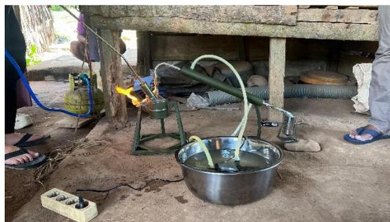
Gambar 11. Proses pembakaran amalgamasi dengan menggunakan alat retort
