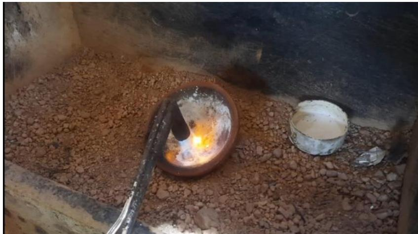
Gambar 10. Proses pembakaran amalgams dengan menggunakan metode tradisional dimana amalgam dibakar diudara terbuka sehingga uap merkuri menempel/menkontaminasi lingkungan sekitar terutama pembakar itu sendiri.
