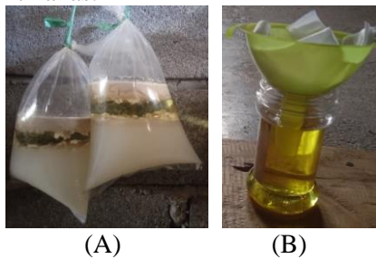
Gambar 4. Proses produksi dan penyaringan VCO menggunakan enzim
